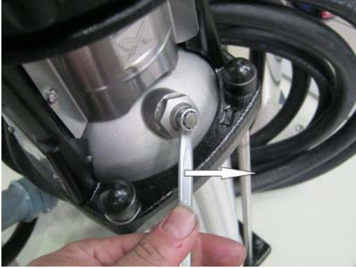
Figura 4-1: Aprire la vite di sfiato
