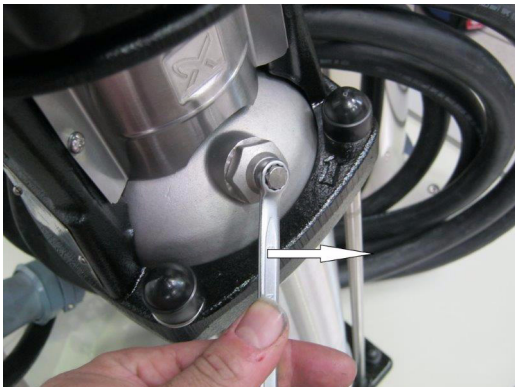
Attēls 4-1: Atgaisošanas skrūves atskrūvēšana
