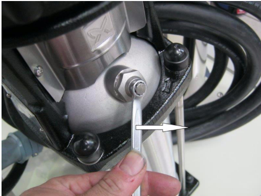
Ilustración 4-1: Abrir el tornillo de purga
