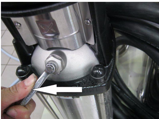
Ilustración 4-3: Cerrar el tornillo de purga
