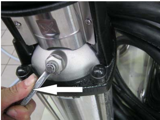
Abbildung 4-3: Entlüftungsschraube schließen
